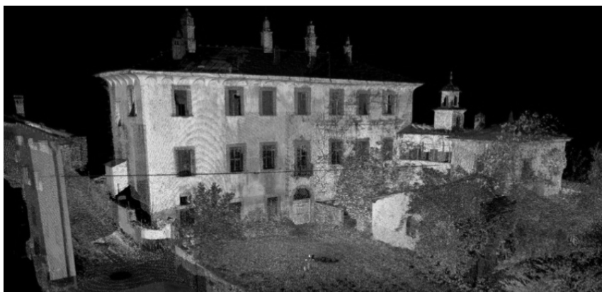
Fig. 4. Nuvola di punti ottenuta dal rilievo laser scanner del complesso
