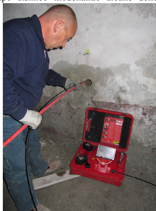
Fig. 2 - Rilievo con video-endoscopia a colori nei fori di carotaggio
