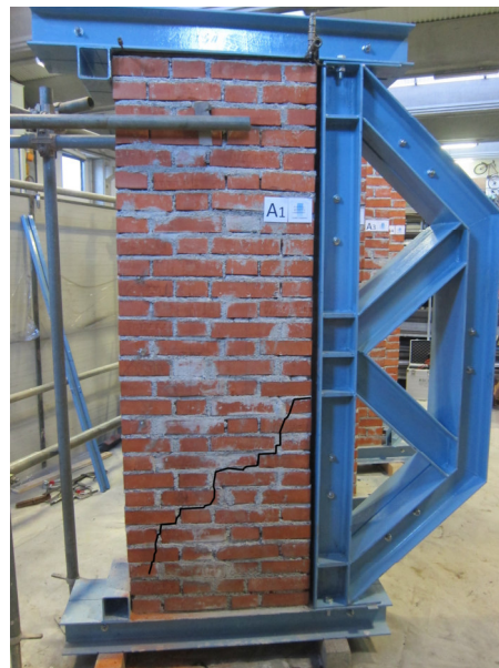
Figura 5. Campioni di laboratorio fessurati dopo la prova FJ-SCT
