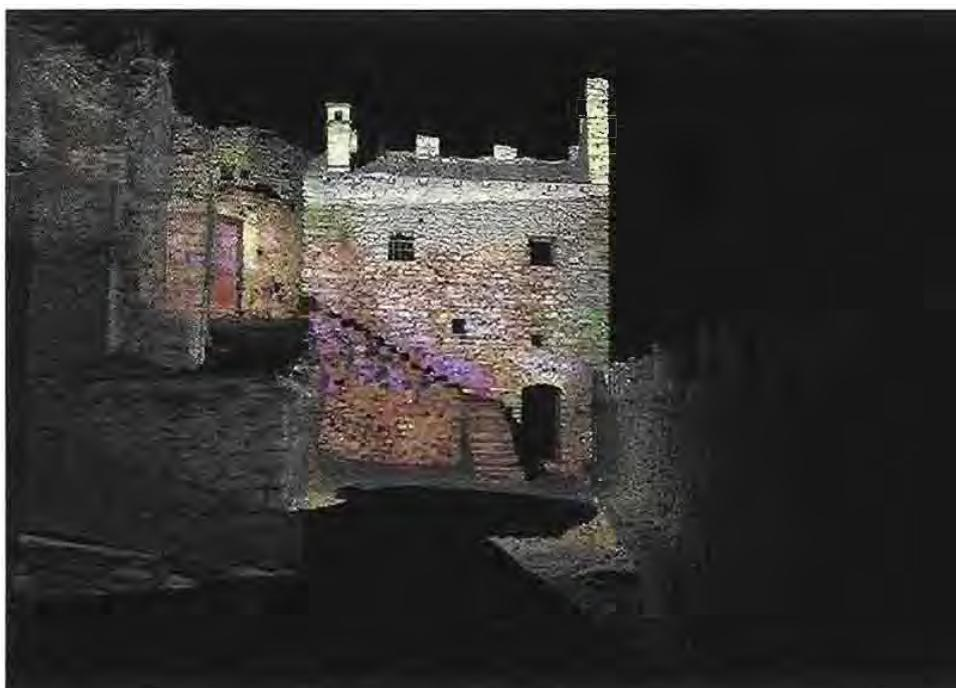
Modello tridimensionale realizzato con tecnologia laser-scan.
