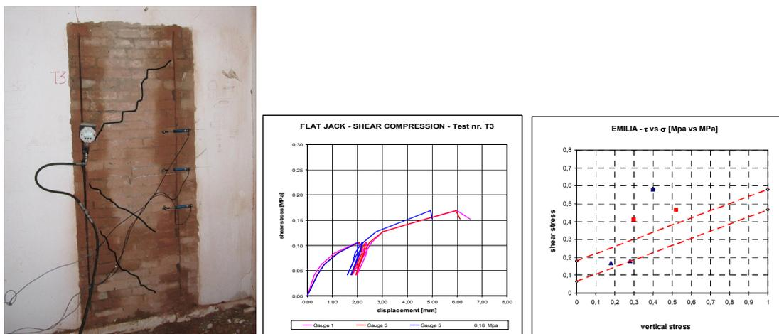
**Figure 9** Campione di muratura sottoposto a prove di taglio FJ-SCT con le tipiche fessure diagonali; diagramma tensione-spostamento e relazione di Coulomb
